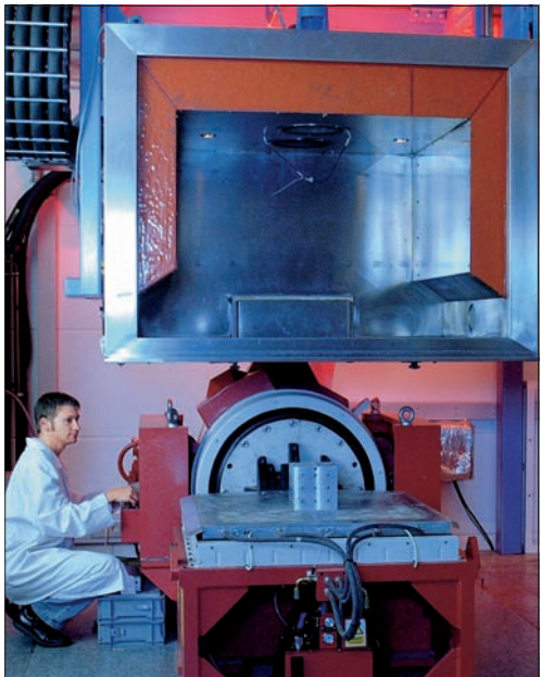
Abb. 19: Maschine zur Durchführung des Highly Accelerated Life Test (HALT)
