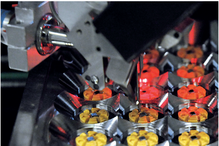
Abb. 11: Bonden des Siliziumchips und Headers
